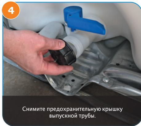
4 Снимите предохранительную крышку выпускной трубы.
