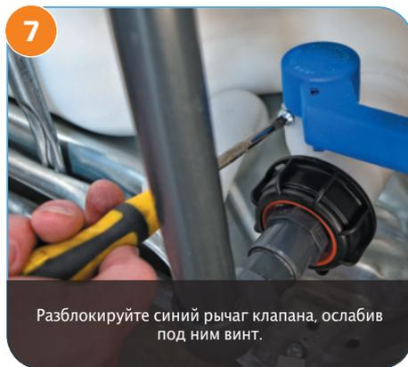
7 Разблокируйте синий рычаг клапана, ослабив под ним винт.
