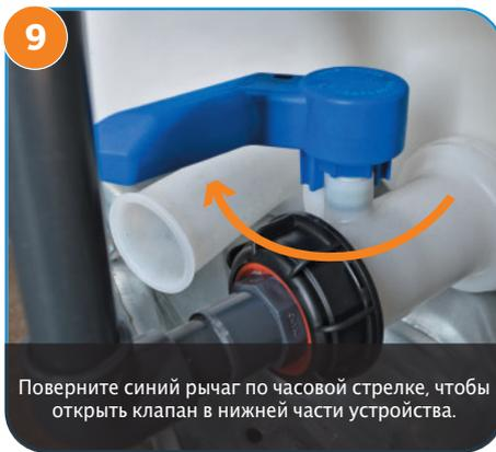
9 Поверните синий рычаг по часовой стрелке, чтобы открыть клапан в нижней части устройства.
