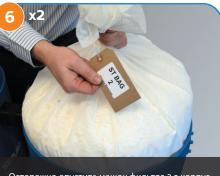
Осторожно опустите мешок фильтра 2 в корпус сепаратора сверху на мешок фильтра 1.
