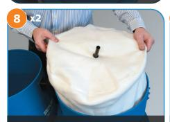
Вставьте оставшийся фильтр (в мешке из иглопробивного войлока) с соединительной трубкой сверху.
