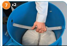
Установите фиксирующие пружинные зажимы под углом 90 градусов в непосредственном контакте с мешками фильтра, чтобы предотвратить их всплывание.
