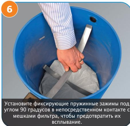
6 Установите фиксирующие пружинные зажимы под углом 90 градусов в непосредственном контакте с мешками фильтра, чтобы предотвратить их всплывание.
