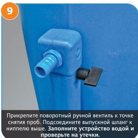
9 Прикрепите поворотный ручной вентиль к точке снятия проб. Подсоедините выпускной шланг к ниппелю выше. Заполните устройство водой и проверьте на утечки.
