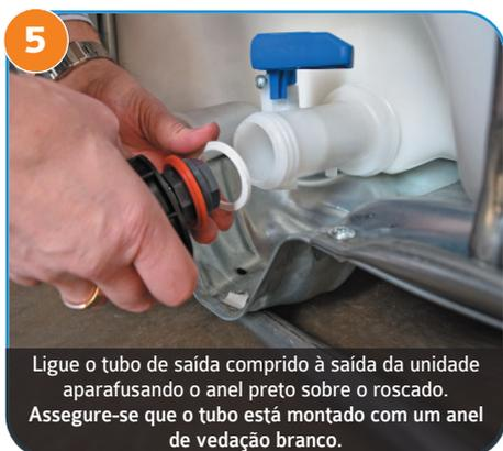
5 Ligue o tubo de saída comprido à saída da unidade aparafusando o anel preto sobre o roscado. Assegure-se que o tubo está montado com um anel de vedação branco.
