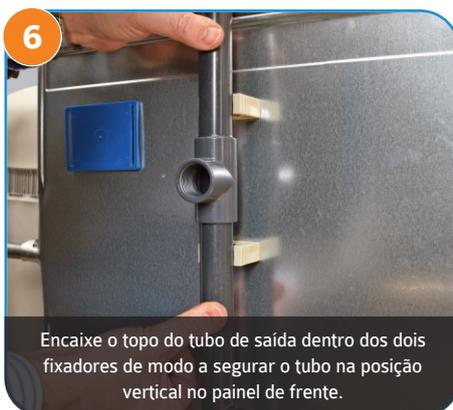
6 Encaixe o topo do tubo de saída dentro dos dois fixadores de modo a segurar o tubo na posição vertical no painel de frente.
