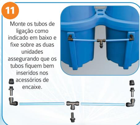
11 Monte os tubos de ligação como indicado em baixo e fixe sobre as duas unidades assegurando que os tubos fiquem bem inseridos nos acessórios de encaixe.
