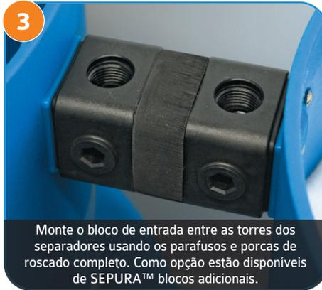
Monte o bloco de entrada entre as torres dos separadores usando os parafusos e porcas de roscado completo. Como opção estão disponíveis de SEPURA™ blocos adicionais.
