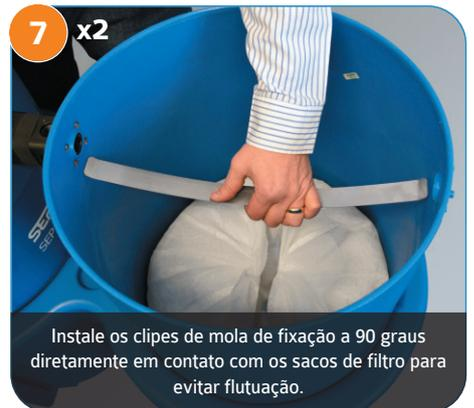
Instale os cliques de mola de fixação a 90 graus diretamente em contato com os sacos de filtro para evitar flutuação.
