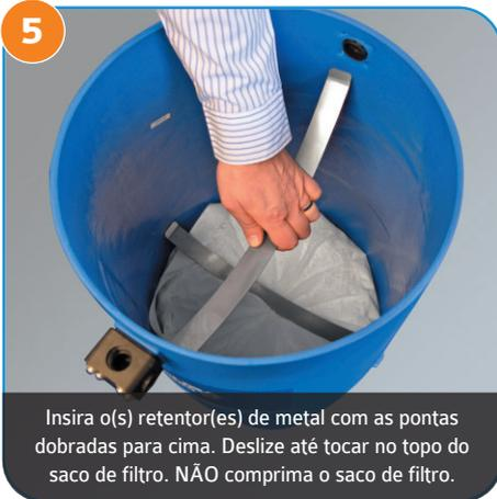
5 Insira o(s) retentor(es) de metal com as pontas dobradas para cima. Deslize até tocar no topo do saco de filtro. NÃO comprima o saco de filtro.
