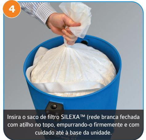
4 Insira o saco de filtro SILEXA™ (rede branca fechada com atilho no topo, empurrando-o firmemente e com cuidado até à base da unidade).
