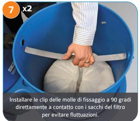
7 x2 Installare le clip delle molle di fissaggio a 90 gradi direttamente a contatto con i sacchi del filtro per evitare fluttuazioni.
