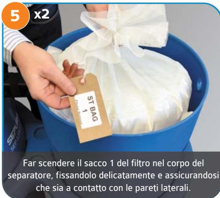
5 x2 Far scendere il sacco 1 del filtro nel corpo del separatore, fissandolo delicatamente e assicurandosi che sia a contatto con le pareti laterali.
