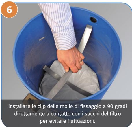
6 Installare le clip delle molle di fissaggio a 90 gradi direttamente a contatto con i sacchi del filtro per evitare fluttuazioni.
