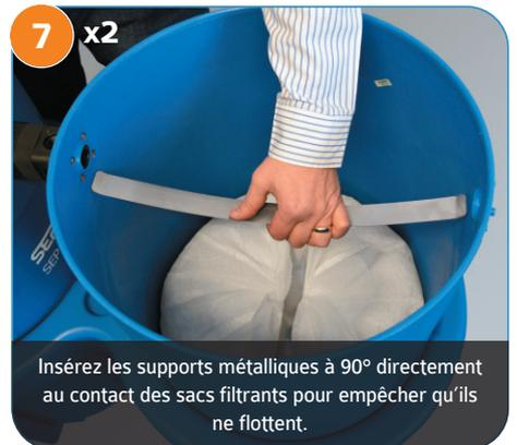
Insérez les supports métalliques à 90° directement au contact des sacs filtrants pour empêcher qu'ils ne flottent.
