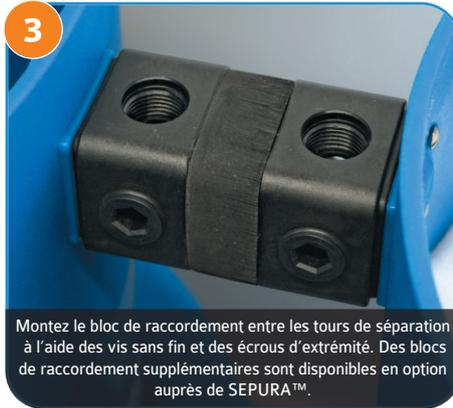
Montez le bloc de raccordement entre les tours de séparation à l'aide des vis sans fin et des écrous d'extrémité. Des blocs de raccordement supplémentaires sont disponibles en option auprès de SEPURA™.
