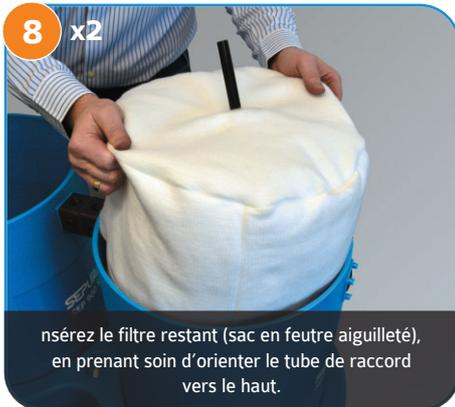
Insérez le filtre restant (sac en feutre aiguilleté), en prenant soin d'orienter le tube de raccord vers le haut.
