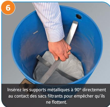
Insérez les supports métalliques à 90° directement au contact des sacs filtrants pour empêcher qu'ils ne flottent.
