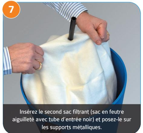
Insérez le second sac filtrant (sac en feutre aigüilleté avec tube d'entrée noir) et posez-le sur les supports métalliques.
