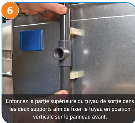
6 Enfoncez la partie supérieure du tuyau de sortie dans les deux supports afin de fixer le tuyau en position verticale sur le panneau avant.
