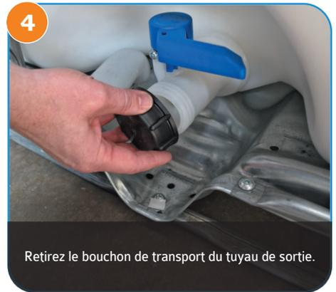
4 Retirez le bouchon de transport du tuyau de sortie.
