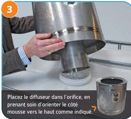
3 Placez le diffuseur dans l'orifice, en prenant soin d'orienter le côté mousse vers le haut comme indiqué.
