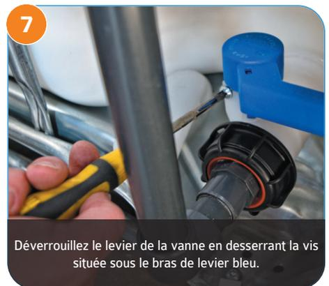
7 Déverrouillez le levier de la vanne en desserrant la vis située sous le bras de levier bleu.
