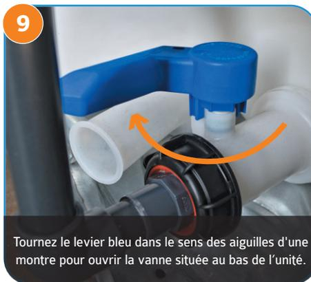
9 Tournez le levier bleu dans le sens des aiguilles d'une montre pour ouvrir la vanne située au bas de l'unité.
