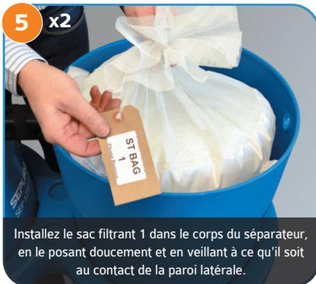
Installez le sac filtrant 1 dans le corps du séparateur, en le posant doucement et en veillant à ce qu'il soit au contact de la paroi latérale.
