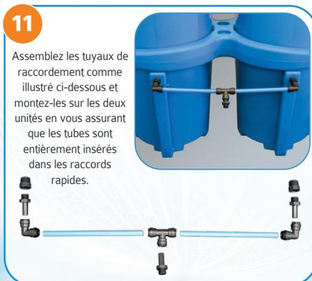
Assemblez les tuyaux de raccordement comme illustré ci-dessous et montez-les sur les deux unités en vous assurant que les tubes sont entièrement insérés dans les raccords rapides.
