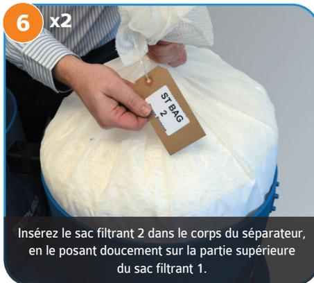
Insérez le sac filtrant 2 dans le corps du séparateur, en le posant doucement sur la partie supérieure du sac filtrant 1.
