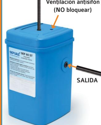
Acople el tubo sobre el conector de salida y alimente el drenaje (lateral). Asegúrese de que exista una caída constante desde el punto de salida hasta el desagüe, sin que se formen dobleces o curvas cerradas.
