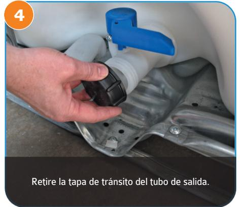
4 Retire la tapa de tránsito del tubo de salida.
