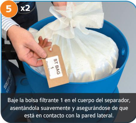
5 x2 Baje la bolsa filtrante 1 en el cuerpo del separador, asentándola suavemente y asegurándose de que está en contacto con la pared lateral.
