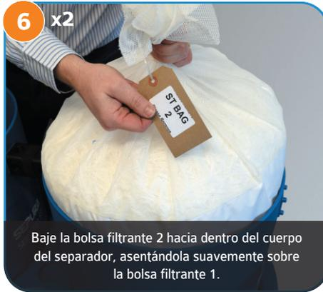
6 x2 Baje la bolsa filtrante 2 hacia dentro del cuerpo del separador, asentándola suavemente sobre la bolsa filtrante 1.
