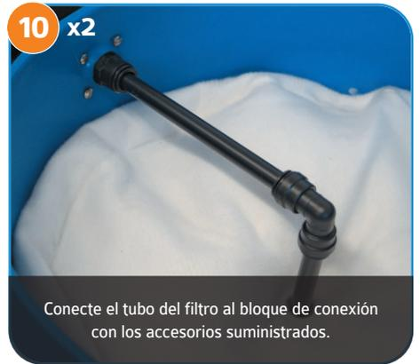
10 x2 Conecte el tubo del filtro al bloque de conexión con los accesorios suministrados.
