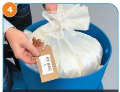
Baje la bolsa filtrante 1 en el cuerpo del separador, asentándola suavemente y asegurándose de que está en contacto con la pared lateral.
