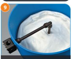
Conecte el tubo del filtro al bloque de conexión con los accesorios suministrados.
