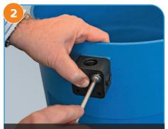
Ajuste el bloque de conexión en el lado elegido usando los tornillos provistos. (Se pueden comprar bloques adicionales si es necesario.)
