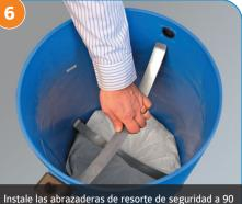
Instale las abrazaderas de resorte de seguridad a 90 grados directamente en contacto con las bolsas filtrantes para evitar la flotación.
