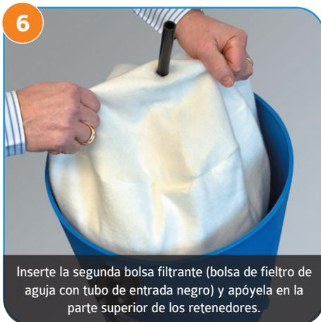
6 Inserte la segunda bolsa filtrante (bolsa de fieltro de aguja con tubo de entrada negro) y apóyela en la parte superior de los retenedores.
