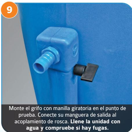
9 Monte el grifo con manilla giratoria en el punto de prueba. Conecte su manguera de salida al acoplamiento de rosca. **Llene la unidad con agua y compruebe si hay fugas.**
