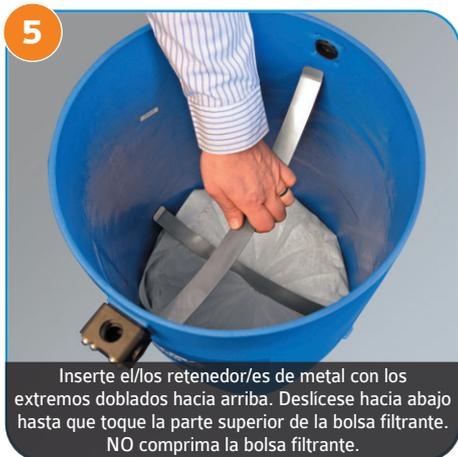
5 Inserte el/los retenedor/es de metal con los extremos doblados hacia arriba. Deslícese hacia abajo hasta que toque la parte superior de la bolsa filtrante. NO comprima la bolsa filtrante.
