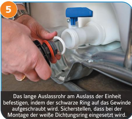
5 Das lange Auslassrohr am Auslass der Einheit befestigen, indem der schwarze Ring auf das Gewinde aufgeschraubt wird. Sicherstellen, dass bei der Montage der weiße Dichtungsring eingesetzt wird.
