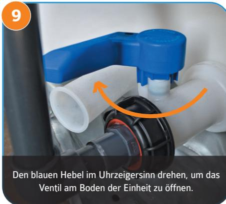
9 Den blauen Hebel im Uhrzeigersinn drehen, um das Ventil am Boden der Einheit zu öffnen.
