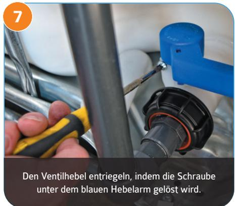
7 Den Ventilhebel entriegeln, indem die Schraube unter dem blauen Hebelarm gelöst wird.
