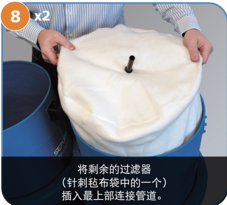
将过滤袋 1 放入分离器机体内，并确保袋子与机器侧壁接触。
