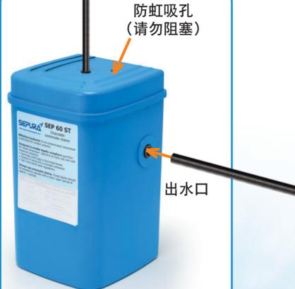
将管道连接至出水口配件，用于排水（侧边位置）。确保从出水口平稳降低至排水处，其间无扭结或急弯。
