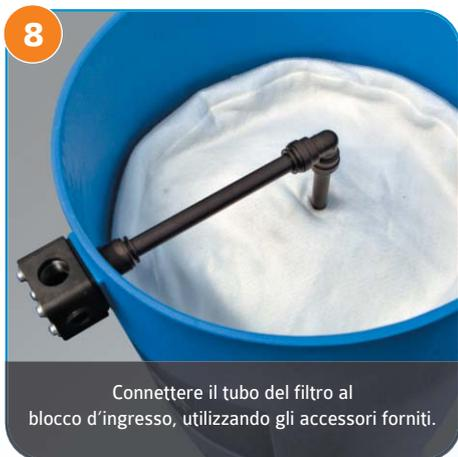
8 Connettere il tubo del filtro al blocco d'ingresso, utilizzando gli accessori forniti.
