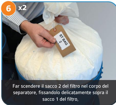
Far scendere il sacco 2 del filtro nel corpo del separatore, fissandolo delicatamente sopra il sacco 1 del filtro,
