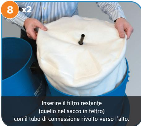
Inserire il filtro restante (quello nel sacco in feltro) con il tubo di connessione rivolto verso l'alto.
