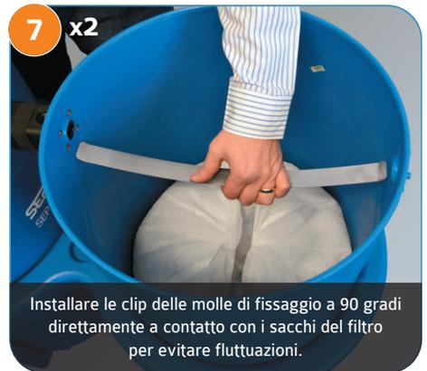
Installare le clip delle molle di fissaggio a 90 gradi direttamente a contatto con i sacchi del filtro per evitare fluttuazioni.
