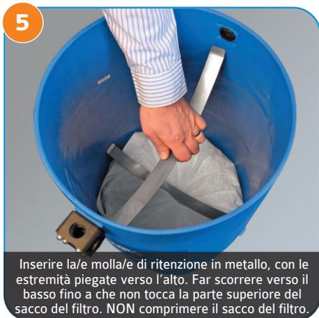
5 Inserire la/e molla/e di ritenzione in metallo, con le estremità piegate verso l'alto. Far scorrere verso il basso fino a che non tocca la parte superiore del sacco del filtro. **NON comprimere il sacco del filtro.**
