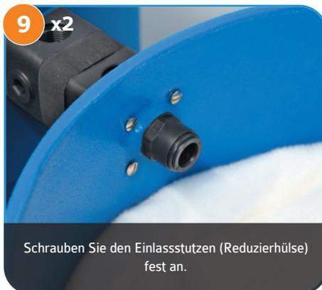
Schrauben Sie den Einlassstutzen (Reduzierhülse) fest an.
