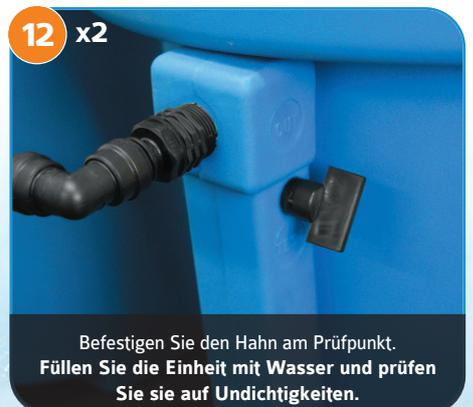
12 Befestigen Sie den Hahn am Prüfunkt. Füllen Sie die Einheit mit Wasser und prüfen Sie sie auf Undichtigkeiten.
