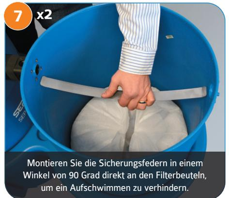
Montieren Sie die Sicherungsfedern in einem Winkel von 90 Grad direkt an den Filterbeuteln, um ein Aufschwimmen zu verhindern.
