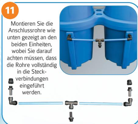
11 Montieren Sie die Anschlussröhre wie unten gezeigt an den beiden Einheiten, wobei Sie darauf achten müssen, dass die Röhre vollständig in die Steckverbindungen eingeführt werden.
