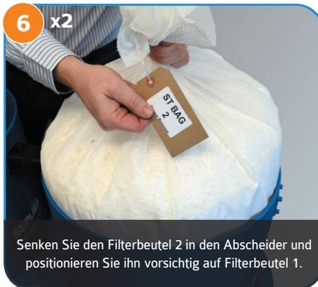
Senken Sie den Filterbeutel 2 in den Abscheider und positionieren Sie ihn vorsichtig auf Filterbeutel 1.
