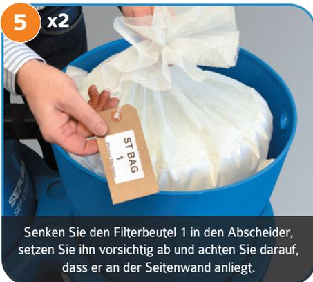
Senken Sie den Filterbeutel 1 in den Abscheider, setzen Sie ihn vorsichtig ab und achten Sie darauf, dass er an der Seitenwand anliegt.
