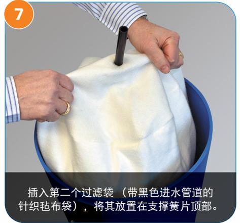
7 插入第二个过滤袋（带黑色进水管道的针织毡布袋），将其放置在支撑簧片顶部。
