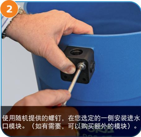
2 使用随机提供的螺钉，在您选定的一侧安装进水口模块。（如有需要，可以购买额外的模块）。
