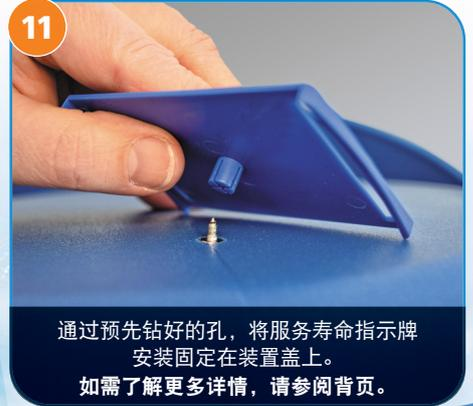
11 通过预先钻好的孔，将服务寿命指示牌安装固定在装置盖上。如需了解更多详情，请参阅背页。
