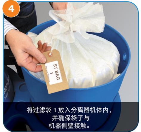
4 将过滤袋 1 放入分离器机体内，并确保袋子与机器侧壁接触。
